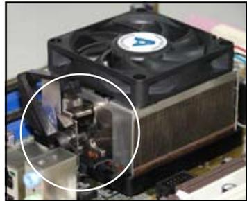
4. Abaissez l'attache de rétention vers le mécanisme de rétention pour fixer le dissipateur et le ventilateur à la base du module.
